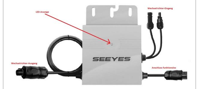
Der Solarkraftzwerg hat eine Netzfreischaltung – das bedeutet der Wechselrichter erkennt, wenn an der Steckdose keine Spannung anliegt und schaltet sofort die Stromlieferung ab. Das ist wichtig bei Elektroarbeiten im Haus oder am Stromversorger-Netz, damit der Solarkraftzwerg im Falle einer Netzabschaltung oder beim Abstecken des Solarkraftzwerges vom Netz keinen Strom mehr liefert und dadurch Menschen gefährdet.
